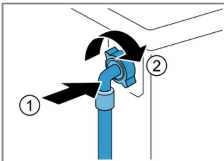
2. Подсоедините наливной шланг к водопроводному крану (26,4 мм = 3/4 дюйма).
