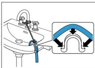
Закрепите и зафиксируйте шланг для слива воды с помощью колена.
