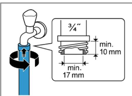
3. Осторожно откройте водопроводный кран и проверьте наличие утечек в местах соединения.
