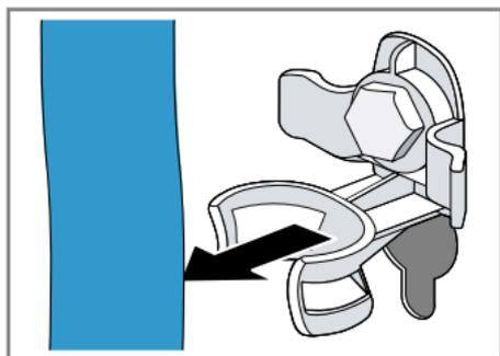
2. Ослабьте все винты 4 транспортировочных болтов с помощью гаечного ключа на 13 мм (1) и снимите (2).
