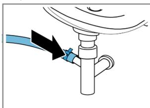
Закрепите место соединения хомутом для шланга (24-40 мм).
